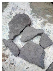
泥浆板框压滤后呈泥饼。
