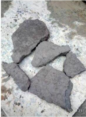
泥浆板框压滤后呈泥饼。
