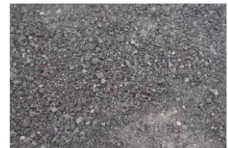
岩屑经振动、冲洗、晾干处理。
