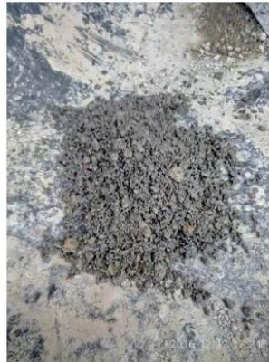
岩屑经振动、冲洗、晾干处理。
