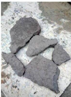
泥浆板框压滤后呈泥饼。
