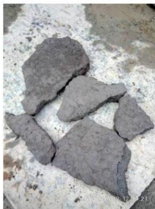
泥浆板框压滤后呈泥饼。
