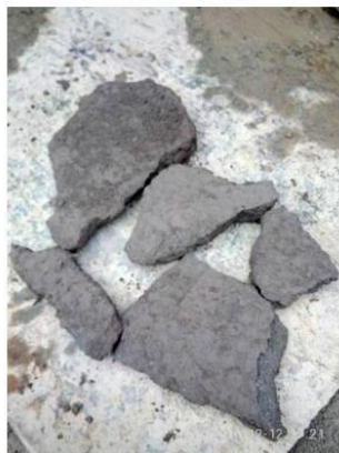
泥浆板框压滤后呈泥饼。
