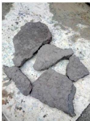
泥浆板框压滤后呈泥饼。
