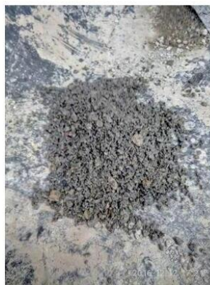
岩屑经振动、冲洗、晾干处理。
