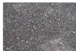
岩屑经振动、冲洗、晾干处理。
