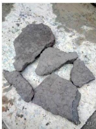
泥浆板框压滤后呈泥饼。
